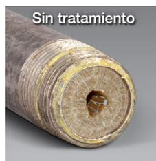
Intercambiador de calor del calentador de agua
