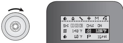
3. Appuyez sur le cadran de commande (🌀) pour sélectionner la température de l'eau chaude sanitaire (🚿). La section mise en évidence clignote.
