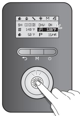
4. Faites tourner le cadran de commande (🌀) vers la droite ou la gauche pour augmenter ou réduire la température.
