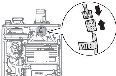
**Remarque** Le clapet inclut un cavalier pour détecteur d'installation d'évent.
