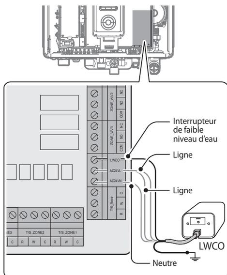
**Remarque** La chaudière fournit une tension de 24 V CA aux bornes d'alimentation de l'interrupteur à faible niveau d'eau (LWCO) (CNC3).
