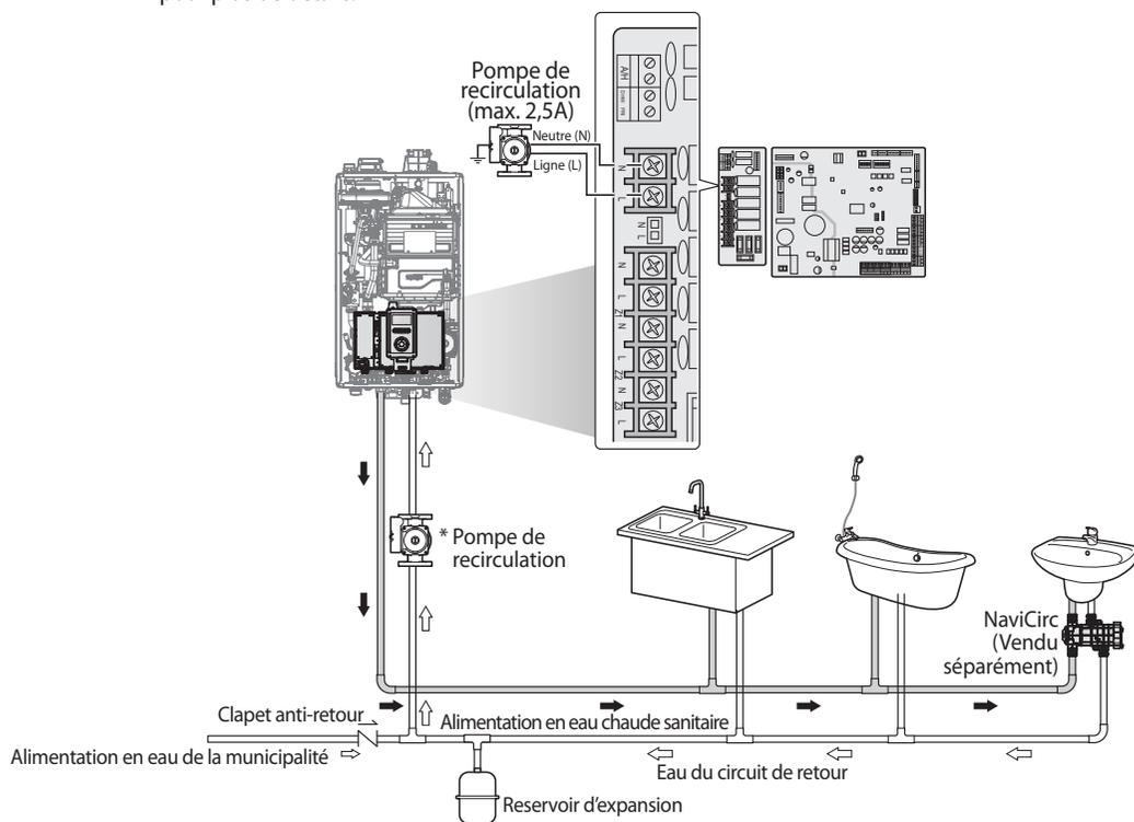
\* Une pompe de circulation Taco 008-BC6 ou Grundfos 15-42 BUC7 (ou l'équivalent) est recommandée pour utilisation avec la chaudière NCB-H et les systèmes de recirculation d'eau chaude sanitaire.
