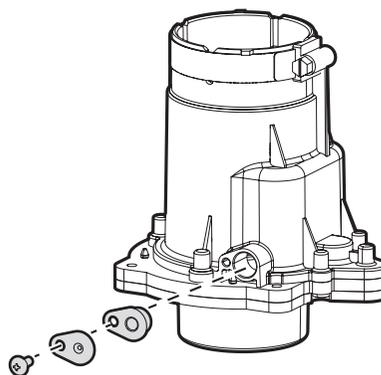
**Remarque** Si du condensat sort par la fenêtre d'entretien lors de l'ouverture, inspectez le drainage et les obstructions possibles.
