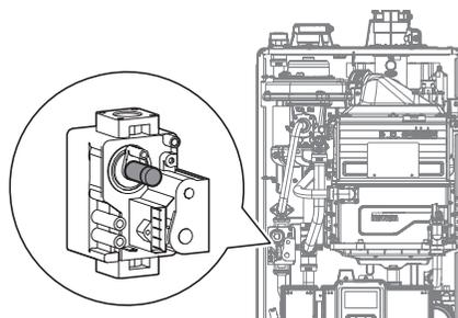
Figure 10. Emplacement de la vis de réglage
