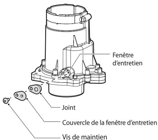
2. Par la fenêtre d'entretien, vérifiez l'état de fonctionnement du battant du clapet de l'ensemble de collet pour ventilation commune.
