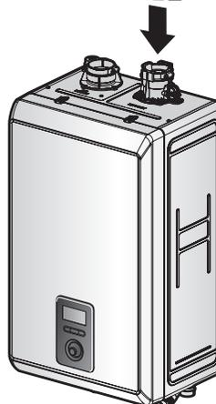
2. Insérez le tuyau dans le manchon de l'événement pour créer la première section du conduit de ventilation. Assurez-vous d'insérer le tuyau complètement dans le manchon, jusqu'à ce que l'extrémité entre en contact avec le fond de la prise.
