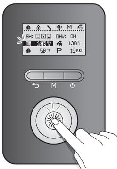
3. Faites tourner le cadran de commande (☀️) vers la droite ou la gauche pour augmenter ou réduire la température.
