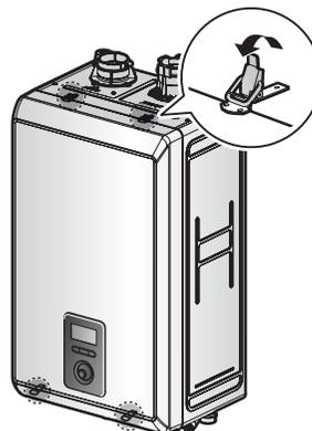
9. Desserrez les vis indiquées sur la figure ci-dessous et branchez un manomètre à la lumière de refoulement. Remettez le manomètre à zéro avant de l'utiliser.
