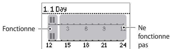
Faites tourner le cadran de commande (🌀) pour choisir l'heure planifiée. Vous pouvez choisir l'heure par intervalles de 30 minutes. Pour achever la programmation hebdomadaire, appuyez sans relâcher sur le cadran de commande (🌀) pendant plus de 2 secondes.
