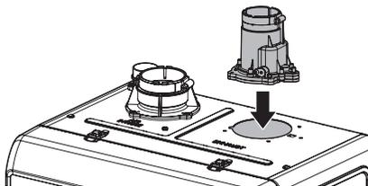
4. Serrez les quatre vis de montage afin de fixer l'ensemble de collet pour ventilation commune en place. Les vis (4) sont fournies avec l'ensemble de collet pour ventilation commune.
