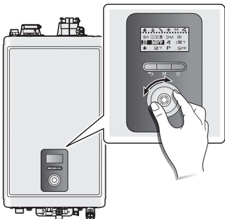
2. Appuyez sur le cadran de commande (☀️) pour sélectionner la température de chauffage des locaux. La section mise en évidence clignote.
