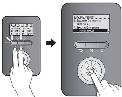
Faites tourner le cadran de commande (⊙) pour passer d'un paramètre à l'autre. Appuyez sur le cadran de commande (⊙) pour exécuter une purge d'air.
