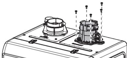
2. Ouvrez le capot avant. Enlevez l'adaptateur du conduit d'évacuation du dessus de l'appareil. Détachez le câblage du détecteur d'installation d'évent (VID) du faisceau.
