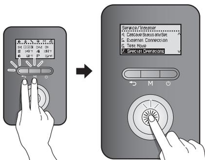
4. Faites tourner le cadran de commande (⌚) pour sélectionner **7. SH 2nd MAX (CL 2e MAX)**, puis appuyez sur le cadran de commande (⌚) pour sélectionner le mode de fonctionnement.
