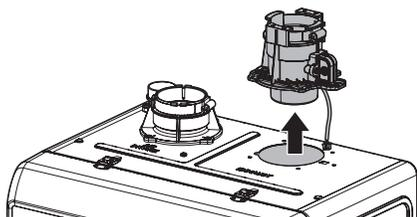
3. Raccordez l'ensemble de collet pour ventilation commune au conduit d'évacuation de la chaudière.
