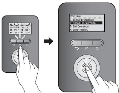
Faites tourner le cadran de commande (🌀) pour passer d'un élément à l'autre dans la liste et pour augmenter ou réduire les valeurs de réglage. Appuyez sur le cadran de commande (🌀) pour sélectionner un élément ou confirmer une modification.
