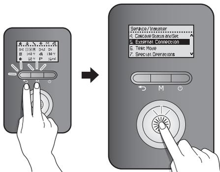
Faites tourner le cadran de commande (⦿) pour passer d'un paramètre à l'autre et pour augmenter ou réduire les valeurs de réglage. Appuyez sur le cadran de commande (⦿) pour sélectionner un paramètre ou confirmer une modification.
