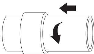
3. Tenez le tuyau et le raccord du tuyau ensemble pendant environ 15 secondes, jusqu'à ce que l'adhésif prenne.
