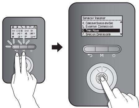
Faites tourner le cadran de commande (⊙) pour passer d'un test à l'autre. Appuyez sur le cadran de commande (⊙) pour exécuter un test.
