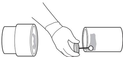
2. Alignez ensuite le tuyau avec le raccord et faites faire un quart de tour au tuyau lorsque vous l'insérez dans le raccord. Le fait de tourner le tuyau permet d'étendre également l'adhésif à solvant organique pour ainsi créer un joint solide et étanche.
