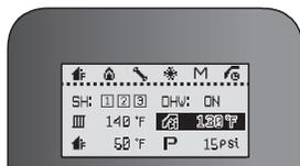
3. Appuyez sur le cadran de commande (🌀) pour sélectionner la température de l'eau chaude sanitaire (🏠). La section mise en évidence clignote.
