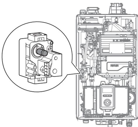
Figure 8. Emplacement de la vis de réglage
