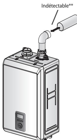
\*\*Le DIV ne peut pas détecter si le tuyau de ventilation fuit ou se déconnecte à un point quelconque entre la chaudière et l'emplacement de ventilation extérieur ou si la ventilation est bloquée pour une raison quelconque.
