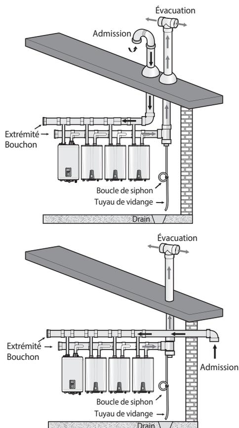
Pour installer un dispositif de vidange du condensat au système en cascade :
