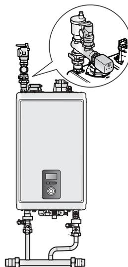
L'interrupteur à faible niveau d'eau (LWCO) externe doit être installé à au moins 152 mm (6 po) au-dessus de la partie supérieure de l'échangeur thermique. Reportez-vous au diagramme suivant pour connaître le raccordement générique du câblage de l'interrupteur à faible niveau d'eau à la carte de circuits imprimés de la chaudière.
