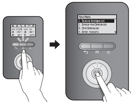
Faites tourner le cadran de commande (🌀) pour passer d'un élément d'information à l'autre. Appuyez sur le cadran de commande (🌀) pour sélectionner un élément et afficher l'information.
