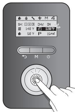
4. Faites tourner le cadran de commande (🌀) vers la droite ou la gauche pour augmenter ou réduire la température.
