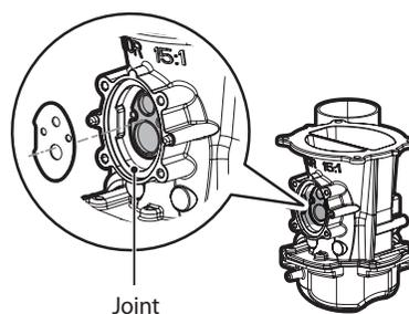
9. Remettez le tuyau d'entrée de gaz à sa position initiale et utilisez toutes les vis pour effectuer tous les raccordements.
