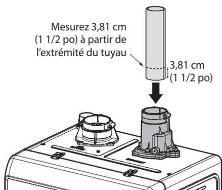
2. Insérez le tuyau de ventilation dans le manchon de l'évent pour créer la première section du conduit de ventilation. Assurez-vous d'insérer le tuyau complètement dans le manchon, jusqu'à ce que l'extrémité entre en contact avec le fond de la prise.
