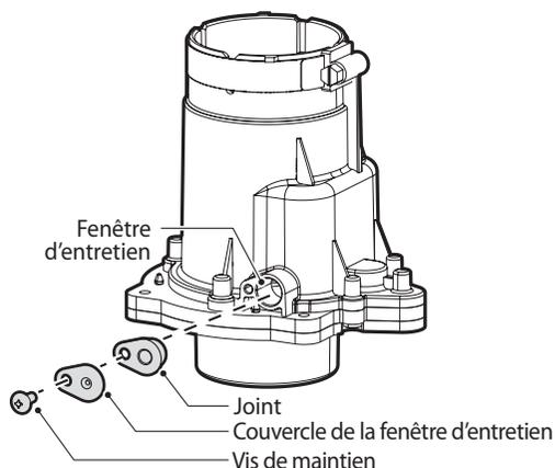
Reportez-vous à la section « 9.9 Entretien » pour consulter les procédures d'inspection détaillées. Clapet anti-refoulement Navien (clapet de refoulement d'air)
