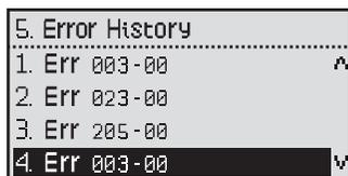
Faites tourner le cadran de commande (🌀) pour passer d'une erreur à l'autre dans la liste. Appuyez sur le cadran de commande (🌀) pour sélectionner une erreur et afficher de l'information détaillée.
