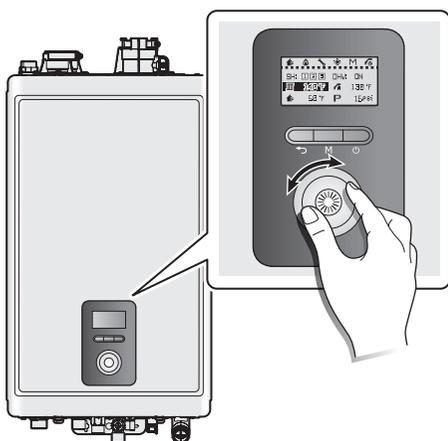
2. Faites tourner le cadran de commande (🌀) vers la droite pour sélectionner la température de l'eau chaude sanitaire.
