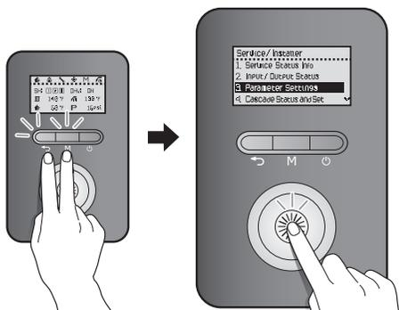
À l'écran du mot de passe, faites tourner le cadran de commande (⌚) pour changer les chiffres et l'emplacement, puis appuyez sur le cadran de commande (⌚) pour saisir le mot de passe.
