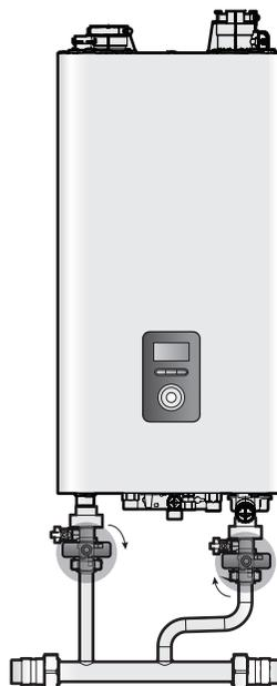
5. Retirez le bouchon de vidange du système d'admission pour vidanger la chaudière.
