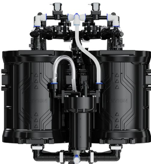
La conception à 2 modules NDI du système WEC assure qu'un module reste toujours disponible pour traiter l'eau si l'autre module est en phase de régénération.
