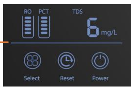
Commandes intelligentes rétroéclairées intuitives avec affichage des MDT, indicateurs numériques de filtration en cours pour chaque filtre et rappels de remplacement des filtres
