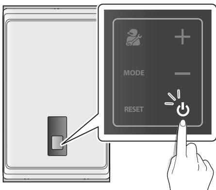
Quand la chaudière est allumée, la température de l'eau d'alimentation s'affiche avec la pression d'eau sur l'écran du panneau avant à intervalles de 5 secondes.
