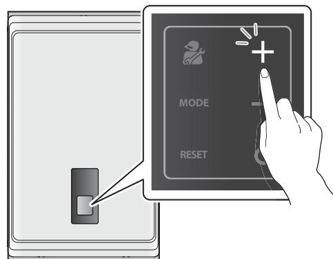
Le réglage de la température s'effectue lorsque l'affichage clignote. Lorsque l'affichage cesse de clignoter, le réglage de la température est enregistré.
