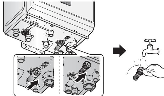
3. Réinsérez le filtre avant de le serrer en place.
