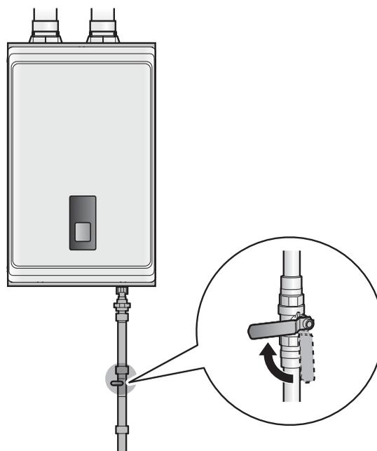
5. Fermez toutes les zones de chauffage qui ne nécessitent pas de vidange et ouvrez une vanne de purge pour vidanger le côté chauffage des locaux. Ouvrez complètement tous les robinets d'eau chaude sanitaire pour vidanger le côté chauffage de l'eau. Le reste d'eau dans les conduites sera évacué.
