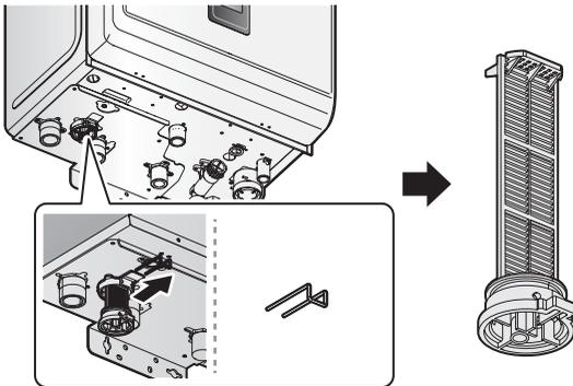
4. Réinsérez et serrez le filtre à tamis.
