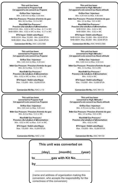
Figure 11. Emplacement des étiquettes de conversion du gaz
