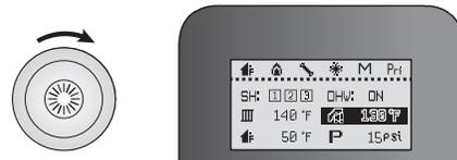
3. Appuyez sur le cadran de commande (🌀) pour sélectionner la température de l'eau chaude sanitaire indirecte (📊). La section mise en évidence clignote.
