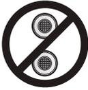
Ne superposez pas verticalement des connexions de sortie concentriques sur un mur latéral. La circulation des gaz d'échappement entraînera un mauvais fonctionnement de la chaudière.
