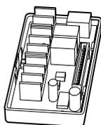
El Navien H2Air es un controlador adicional para calentadores de agua Navien NPE-A2/S2. Suma funciones de entrada y salida a los calentadores para una aplicación de combinación con suministro simultáneo de calefacción de espacios y agua caliente doméstica. Con este controlador, puede instalarse un termostato (de 1 o 2 etapas) y un sensor exterior junto con una unidad de acondicionamiento de aire hidrónica para sumar la funcionalidad de calefacción de espacios al sistema.
